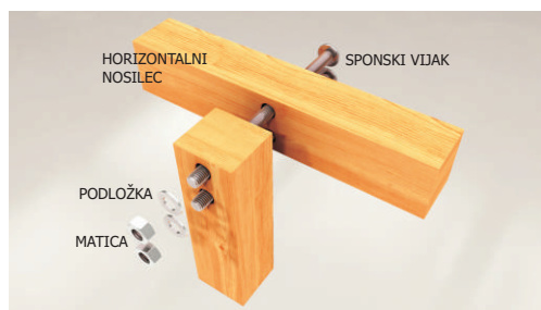
STIK VERTIKALNEGA NOSILCA S HORIZONTALNIM (VELJA ZA POLOŽAJ NA PODU IN STREHI)
